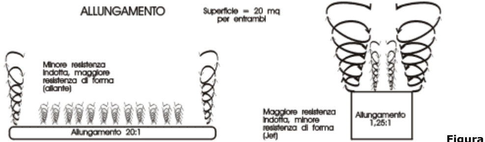
3-24. L'allungamento riduce la resistenza indotta: tale effetto è particolarmente rilevante per gli apparecchi che volano a basse velocità.
