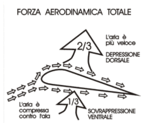
Figura 3-10. Genesi della Forza Aerodinamica Totale, che rende possibile il volo.
